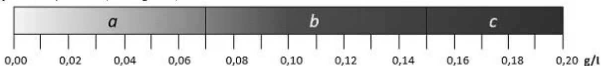
Figura 3. Scala de culori a soluțiilor apoase de colorant: a – insuficient roșie (< 0,07 g/L); b – roșie optimă (0,07-0,15 g/L); c – roșie intensă (> 0,15 g/L)
